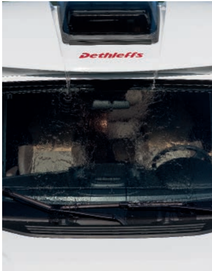
» Sadevesi ohjataan uria pitkin katolta yli tuulilasin ja takaseinän
