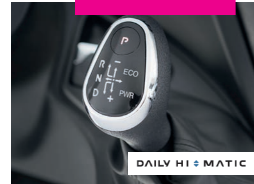
+ 8-portainen automaattivaihteisto HI-MATIC lisää ajomukavuutta ja vähentää polttoaineen kulutusta (lisävaruste)
