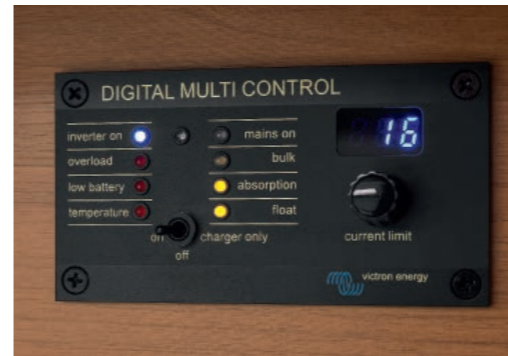
+ Victron Energy Digital MultiControl -sähkökeskuksen käyttöpaneeli ulko-oven yläpuolella (lisävaruste) (4)
