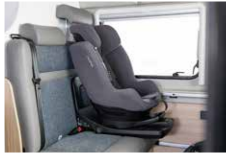
ISOFIX lastenistuimen kiinnittämiseen
