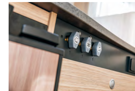
Kaasuventtiilit käden ulottuvilla
